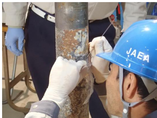
試験体取出し状況(左)と腐食生成物の採取状況(右)
