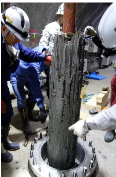
試験体取出し状況(左)と腐食生成物の採取状況(右)
