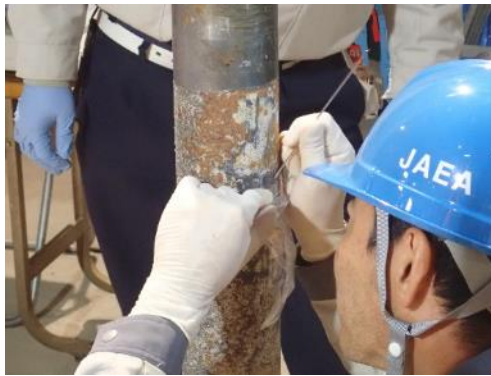
図 85 腐食生成物の採取
