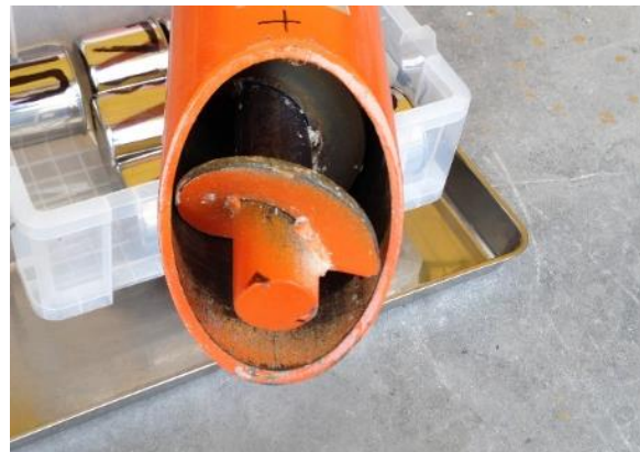
写真 3 下部狭隘部に充填したペレット（左）とスクリーコンベア（右）
