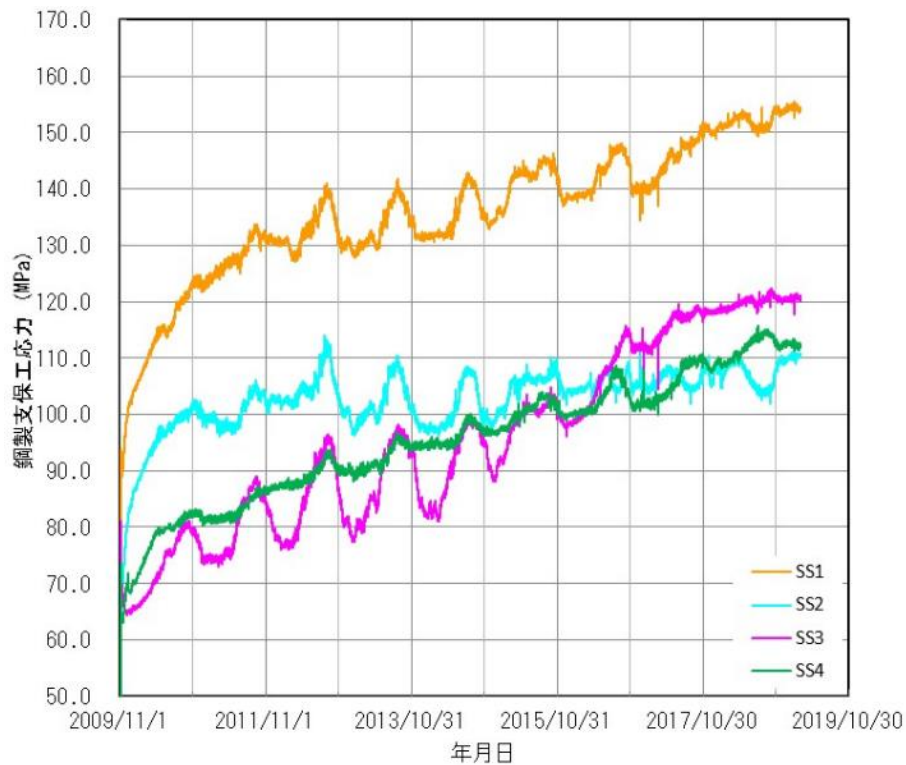
図 49 鋼製支保工応力計の計測結果
