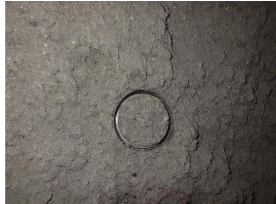
写真 5 吹付け試験の様子（左）とコアサンプリング（右）
