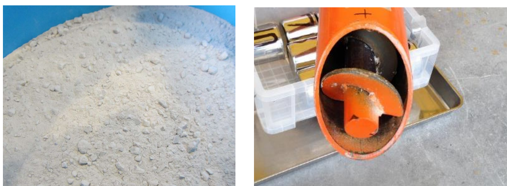
写真3 下部狭隘部に充填したペレット(左)とスクリーコンベア(右)
