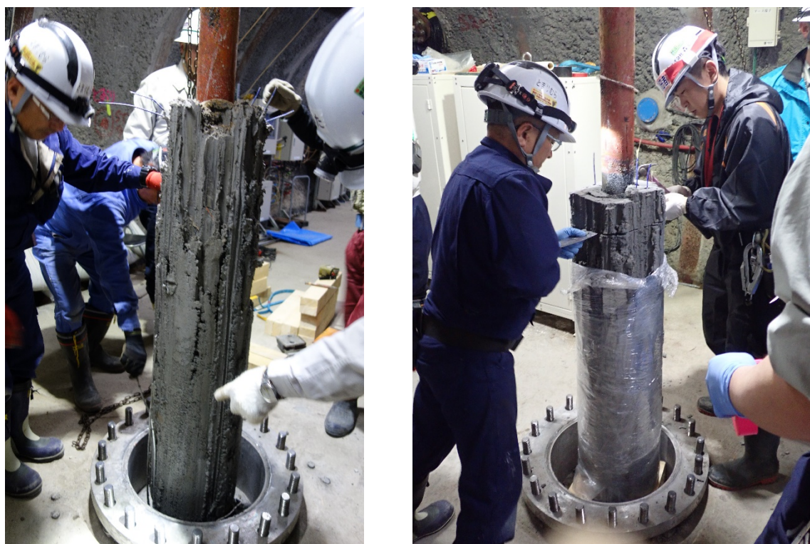
図 84 試験体取り出し状況（左）と緩衝材の解体作業状況（右）
