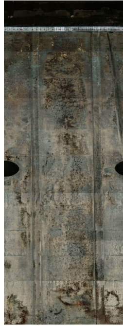
図 76 酸洗処理後の模擬オーバーパック外表面のスキャン画像
