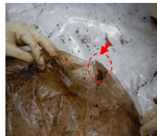
析出物を確認したドラム缶(1本目)の充填用袋の損傷状況
