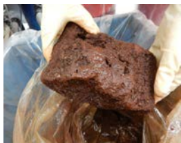
硫酸ナトリウムの結晶を粉砕した硬い内容物
