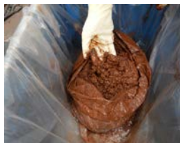
水分を含んだスラッジを回収した柔らかい内容物
