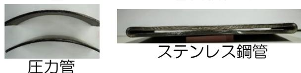
図 20 プレス減容試験結果
