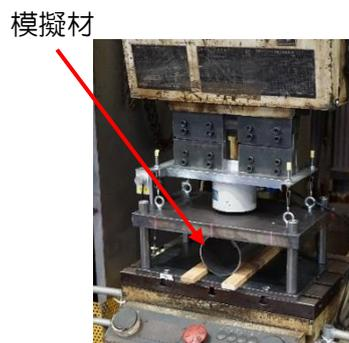
図 19 プレス減容試験状況
