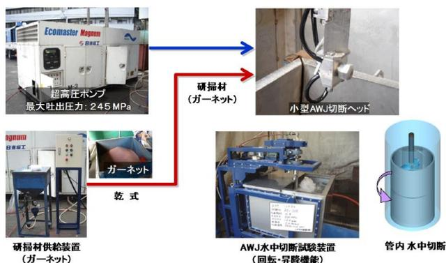
図 16 AWJ 切断の概要
