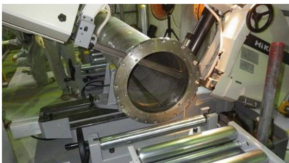
大型バンドソーによる切断
