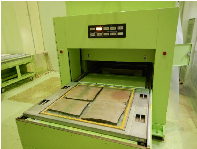
クリアランス測定 クリアランスモニタ室
