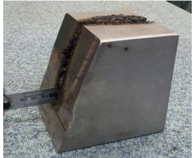
図3 水中で100mm深さまで切断時の切断深さ測定状況
