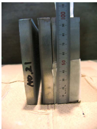
図6 気中で270mm深さまで切断時の切断面状況
