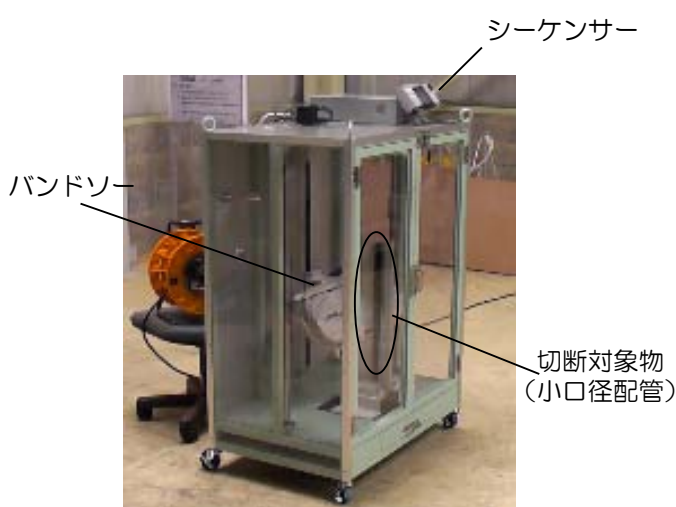
試作品①電動昇降方式配管縦割工具
