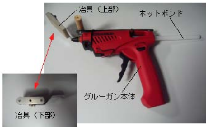
試作品①グルーガンを改良した接着治具
