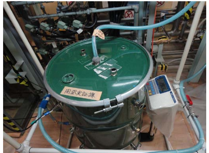
トリチウム除去対象機器を模擬したモックアップ（ドラム缶で製作）
