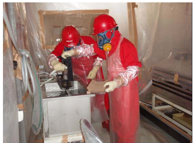
有機酸を用いた中規模試験装置による化学除染試験
