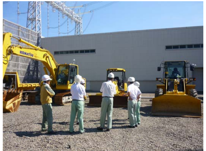
浜岡原子力発電所の緊急時がれき撤去用重機の配備状況
