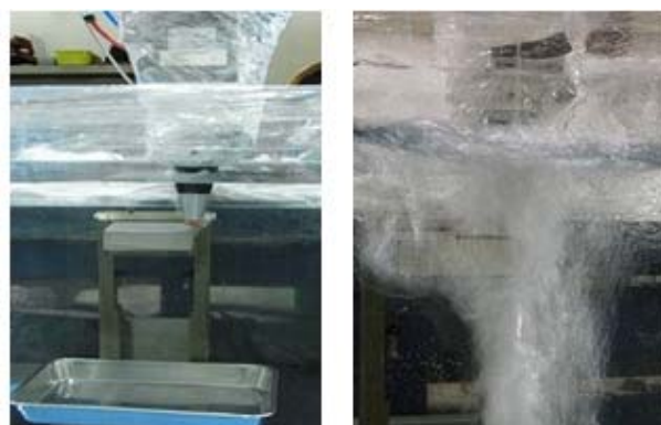
水中レーザー切断試験状況
