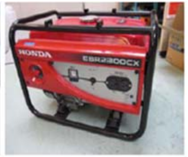
可搬式発電機(2.3kVA)
