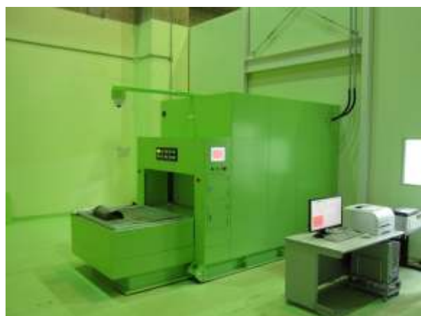
クリアランスレベル検認装置
