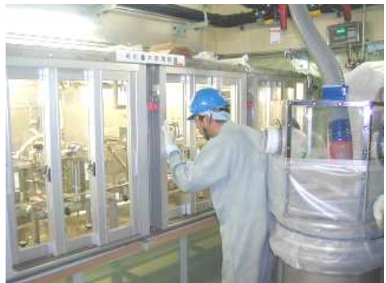
写真5：重水前処理作業の様子
