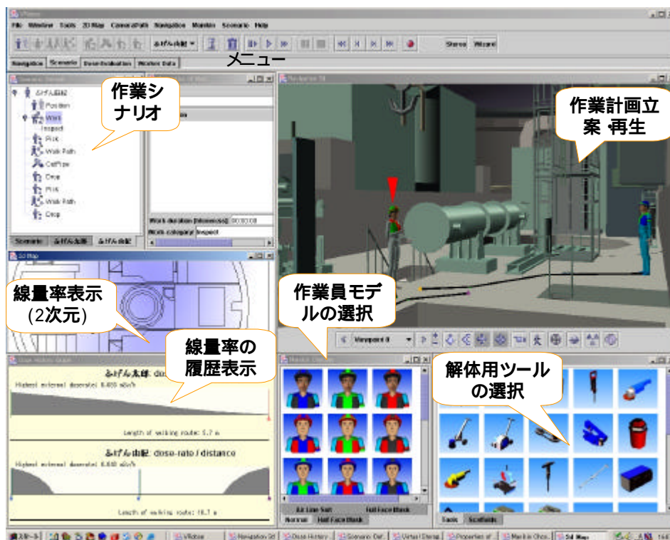
図1 解体作業シミュレーションシステム (VRdose)
