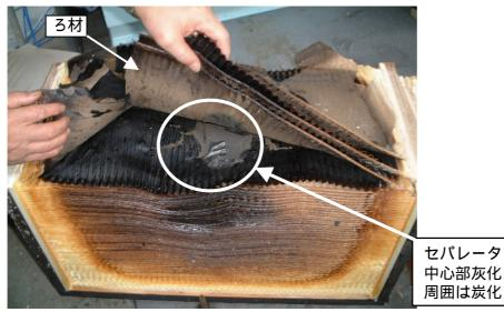
フィルタ燃焼試験後 HEPAフィルタ断面写真
