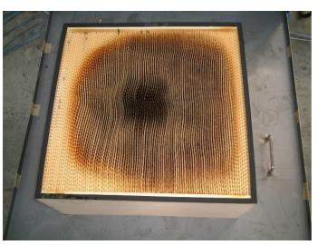
フィルタ燃焼試験後 HEPAフィルタ上面外観写真
