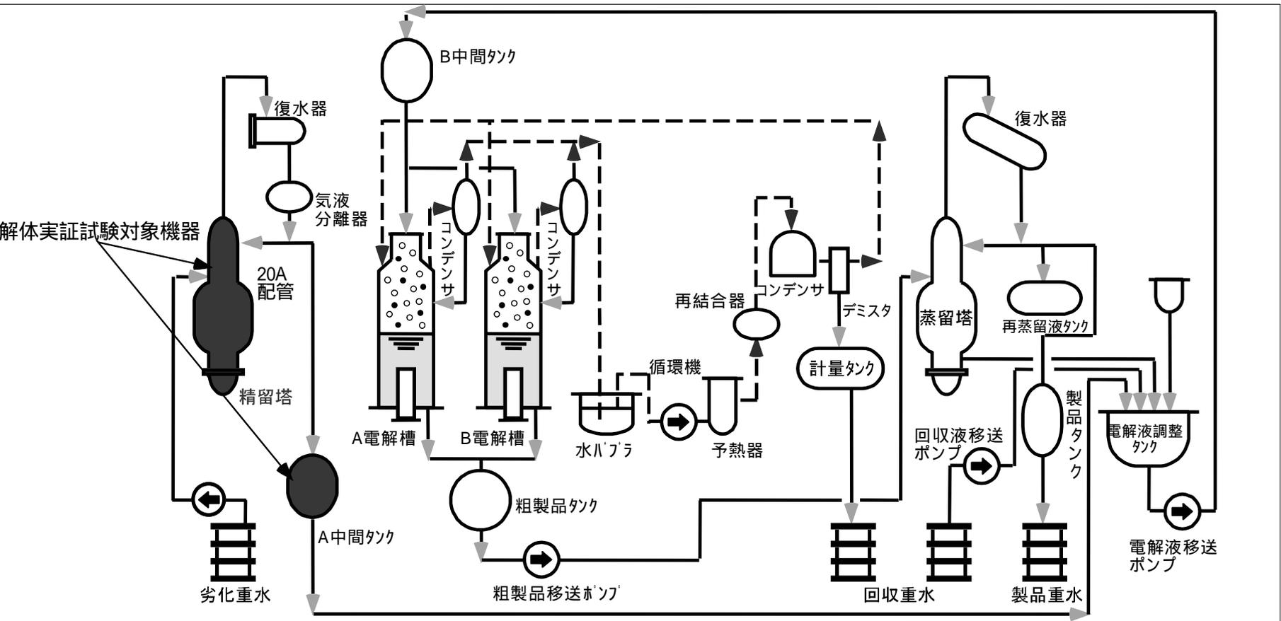
別添 重水精製装置 系統図と解体実証試験対象機器
