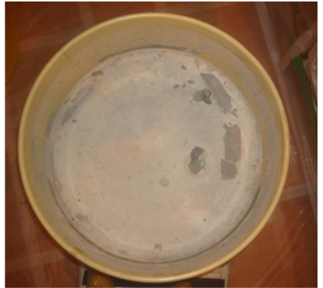
写真7 当該 200Lドラム缶と同日にセメント固化した他の 200Lドラム缶の内部状況
