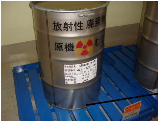
写真1 当該300Lドラム缶の正面底部の漏えい箇所
