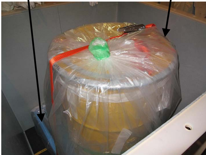
写真8 当該 200Lドラム缶の養生状態
