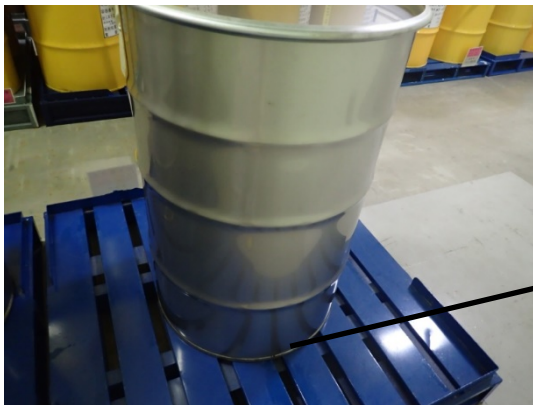
写真1 当該300Lドラム缶の正面底部の漏えい箇所
