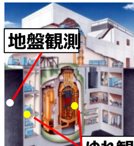
地震観測システム (HTTR(大洗)に設置)
