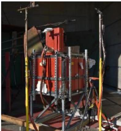
図2 H29年度HEAF試験の試験体
