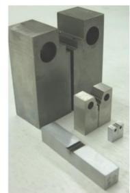
破壊靱性試験片
