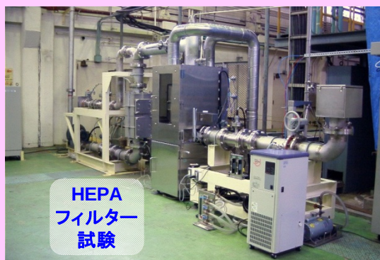
HEPA フィルター 試験 火災時ソースターム実験装置 (火災時閉じ込め安全性評価)
