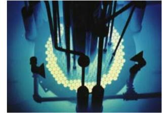
原子炉の出力暴走をNSRRのパルス出力運転により模擬し、RIA時の燃料挙動を解明する。
