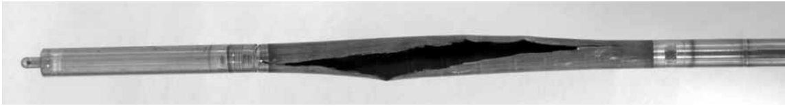
図1 NSRR 実験で破損した燃料棒 (ジルカロイ 4 被覆 PWR-MOX 燃料, 燃焼度: 59 GWd/t)
