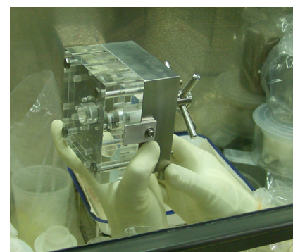
元素の拡散試験後の試料の切断・分析の様子
