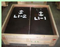
製作した鋼材の一部 (板厚200mm)
