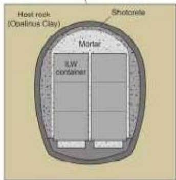
Emplacement tunnel ILW TRU廃棄物
