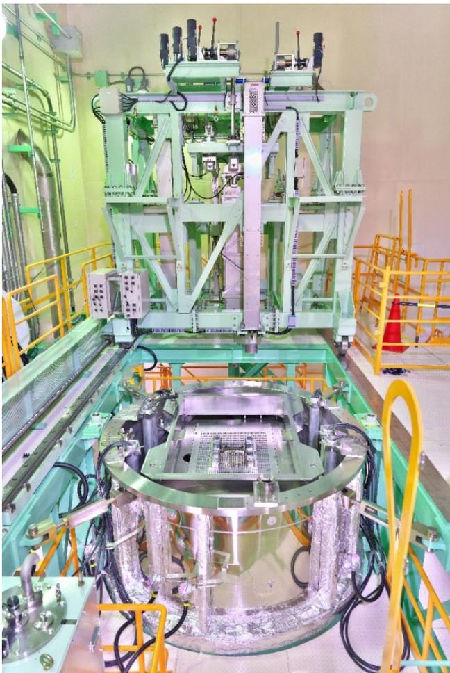
STACY 更新炉の炉心タンクと上部機器
