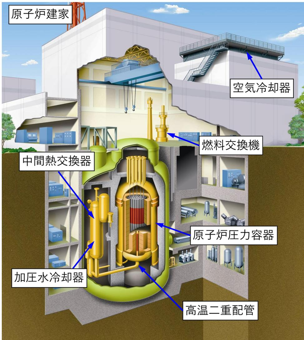
世界で唯一950°Cの熱を取り出せる高温ガス炉
