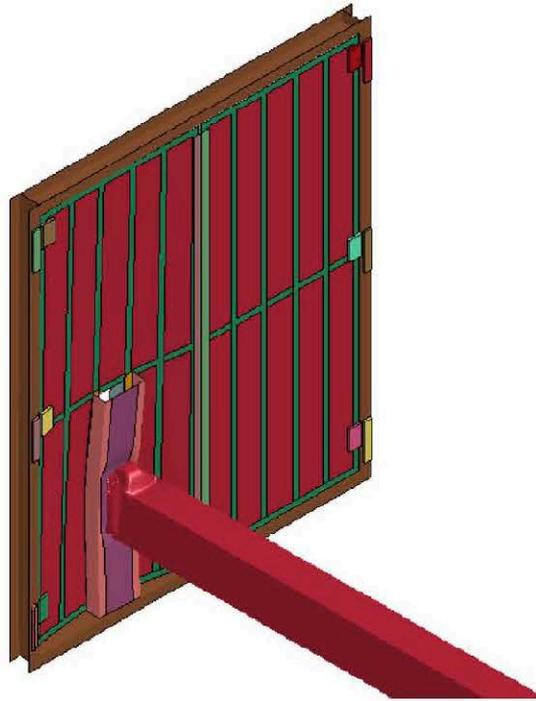
図 5.2-11 防護扉（扉表面）の変形挙動（最終時刻）
