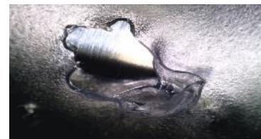
試験による穴 (約4.93mm)
