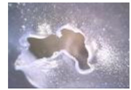
試験による穴 (約6.65mm)
