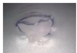
試験による穴 (約4.90mm)
