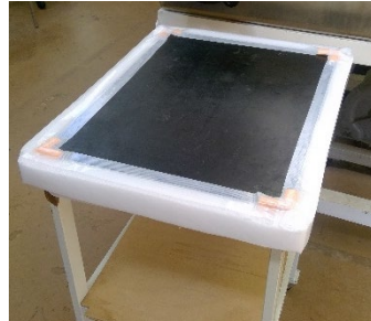
作業台上面周囲を厚さ 30mmの発砲ポリエチレン で囲む
