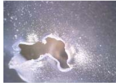
試験による穴(約6.65mm)
