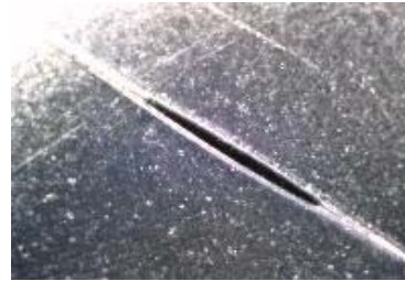
試験による穴(約4.35mm)
