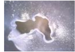
試験による穴 (約6.65mm)
