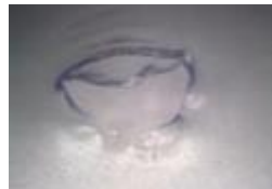
試験による穴 (約4.90mm)
