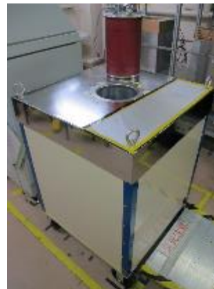
熱外中性子測定装置 (プルトニウム240実効質量を測定)
