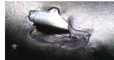
試験による穴 (約4.93mm)
