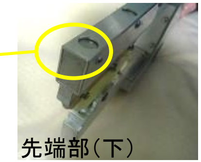
試験に使用した熱溶着装置ヘッド部 (当時使用していたものと同じタイプ)
