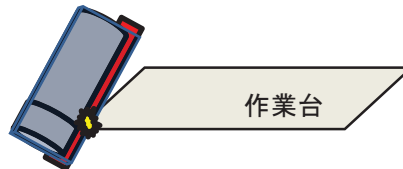
パターン4-2 梱包物を作業台角部 に接触
