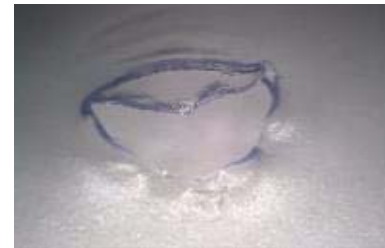
試験による穴(約4.90mm)
