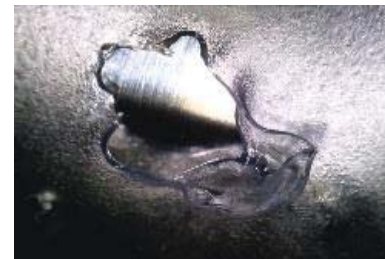
試験による穴(約4.93mm)
