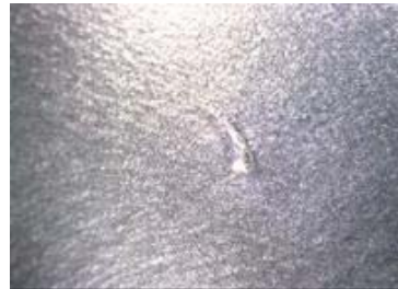
試験による傷(約1.95mm)
