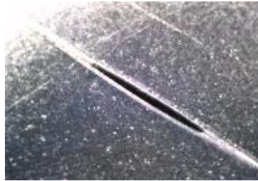
試験による穴(約4.35mm)
