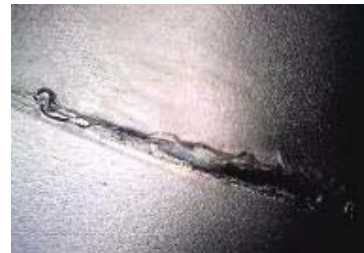
試験による穴(約13.45mm)
