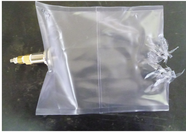
図 7.1.3-参 5 破裂状態の例 No. 9 (放射状)
