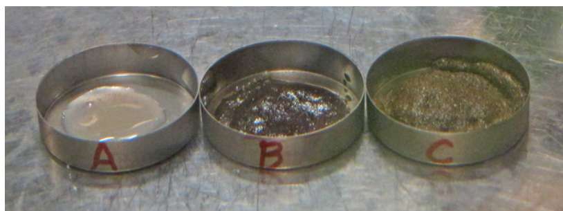
図②-4 16 日目に密閉容器から取り出した試料 C（右端）と解放状態にあった試料 A、B の比較
