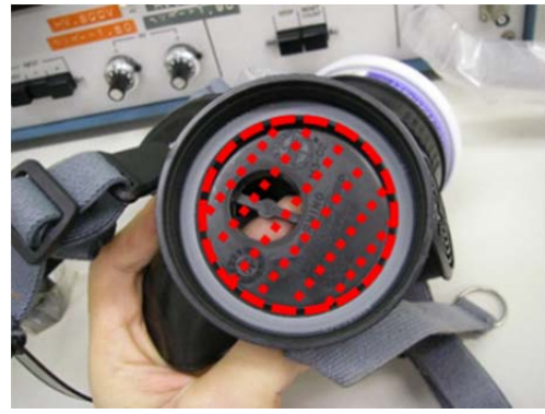
図 6.5.3-5-2 乾式スミヤ試料採取箇所
