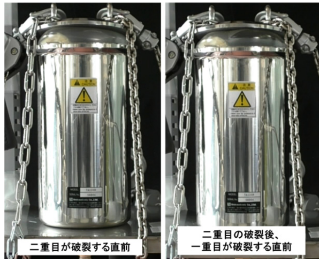
図 7. 1. 3-8 試験②-No. 3 の破裂直前の写真
