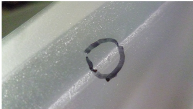
図 7.1.3-参 7 破裂状態の例 No. 11 (穴)
