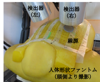
図 6.3.5-6 ^{241}\text{Am} 線源の測定風景
