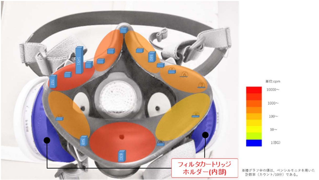
図 6.5.3-3-6 作業員 E の作業時着用半面マスク(半面マスク No.6)の測定結果
