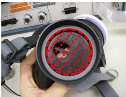
図 6.5.3-3-3 乾式スミヤ試料採取箇所
