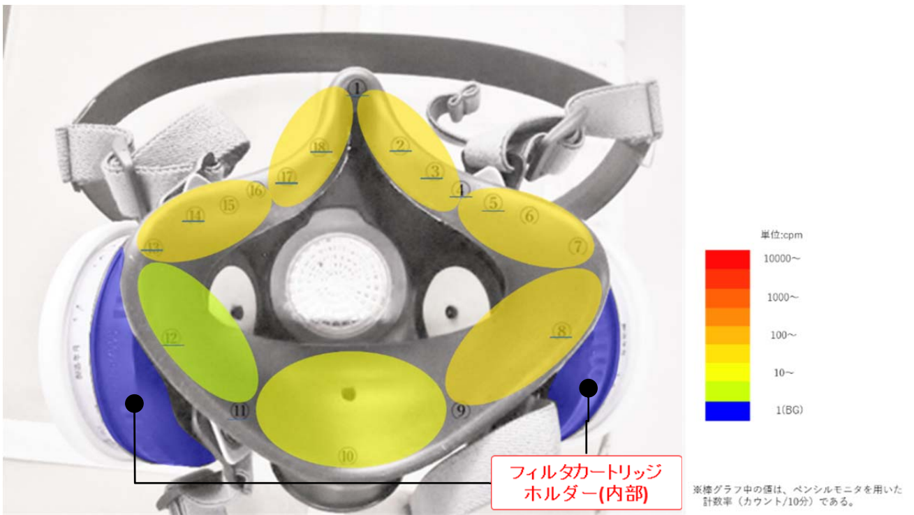
図 6.5.3-3-5 作業員 D の作業時着用半面マスク(半面マスク No.7)の測定結果
