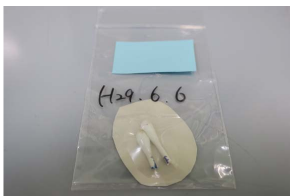
図 4.2.3-1 鼻孔スミヤ試料 (汚染防止のためにポリエチレン袋に入れた状態。 測定時には試料を取り出す。)
