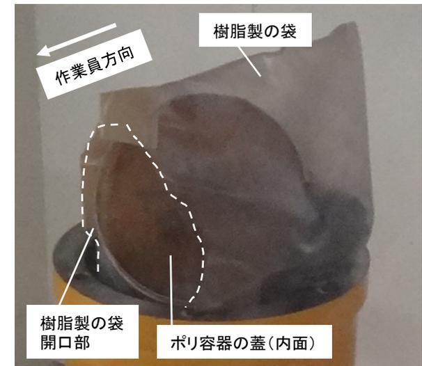
樹脂製の袋の破裂後に作業員が撮影した写真を拡大
