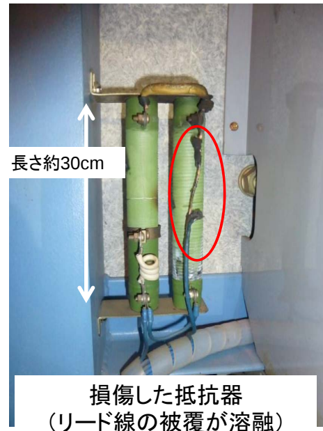
図5 遮断器(投入コイル・抵抗器)の損傷状況
