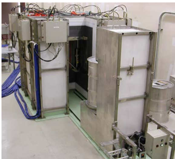
図 2 原子力機構(基礎工)が開発した FNDI 法による廃棄物ドラム缶用 装置の原型機(JAWAS-T)
