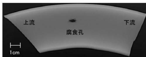
W004配管の汚染部(腐食孔)のRT画像
