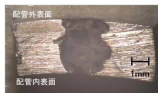
腐食孔の断面部
