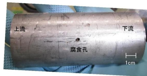
G123 配管外側底面の汚染部(腐食孔)
