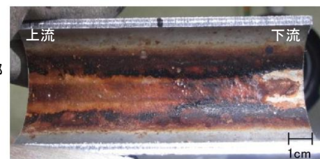
G123 配管底面汚染部 (腐食孔)の内表面
