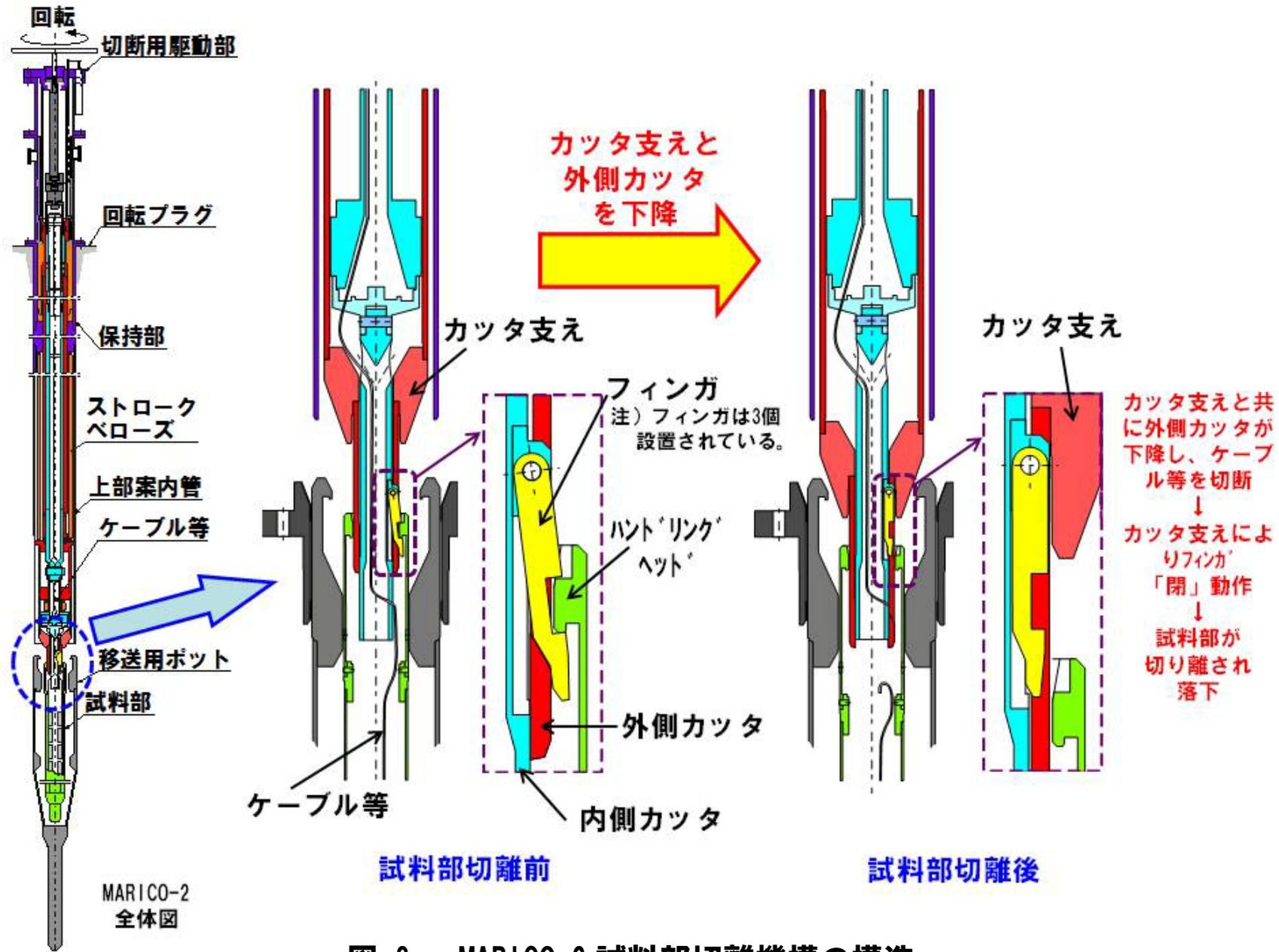
図-3 MARICO-2 試料部切離機構の構造
