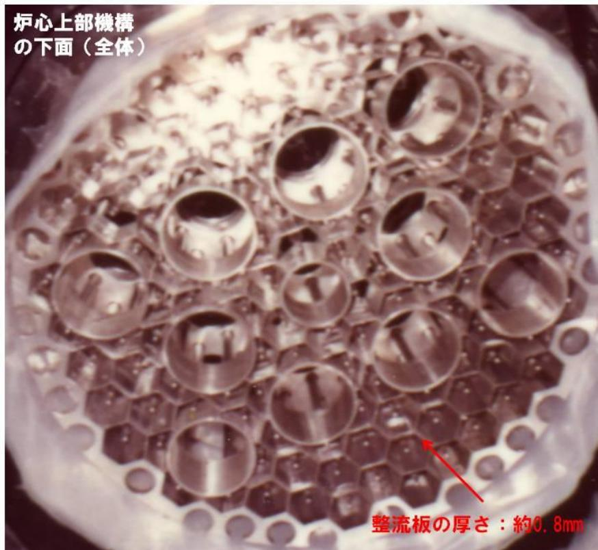
炉心上部機構の外観（建設時に撮影）
