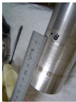
シャフトスリーブ（セツスクリュー取付け部③） シャフトスリーブには①～③までセツスクリューの締付け痕が確認された。
