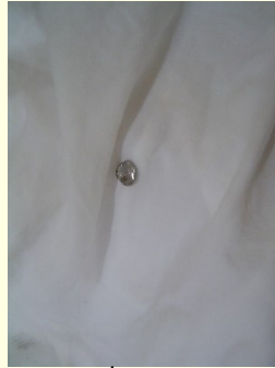
コイルスプリングの間に残っていた磨耗したセツスクリュー
