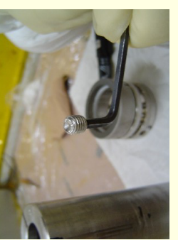
正常な状態のセツスクリュー
