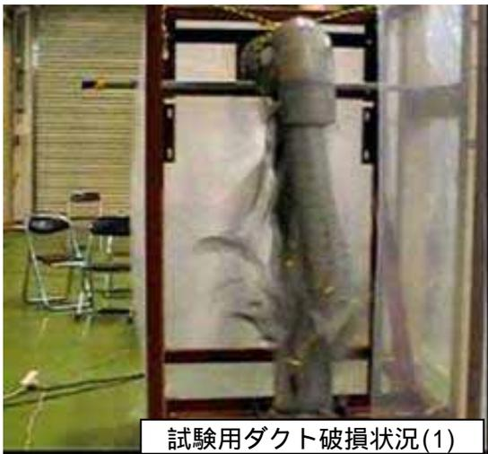
試験用ダクト破損状況(1)
