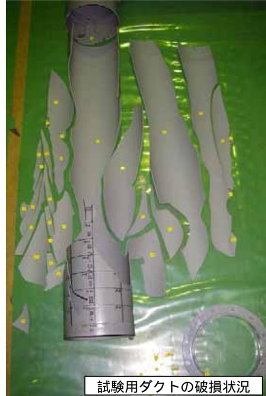
試験用ダクトの破損状況
