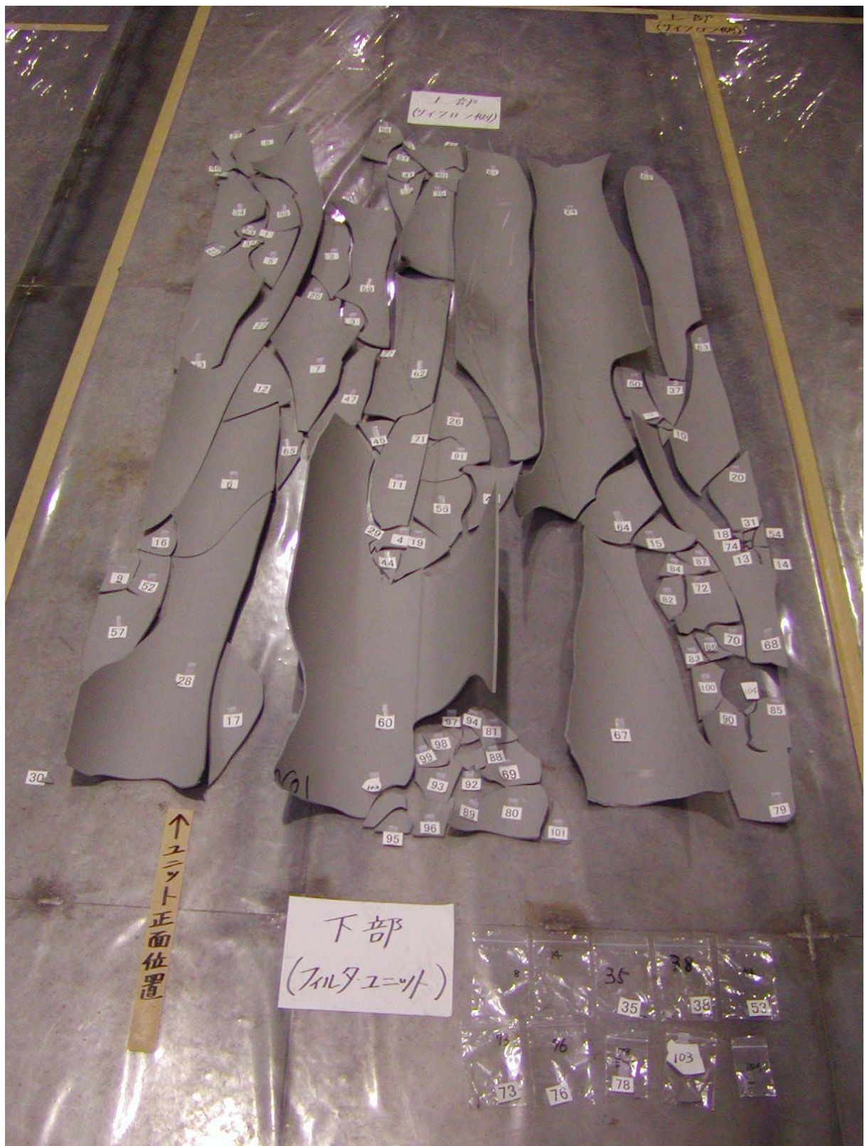
写真-3 排気ダクト破片の復元状態
