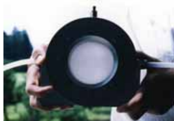
周辺水冷却の機構を備えた 人工ダイヤモンド窓 直径100mm(口径80mm) 厚さ1.85mm
