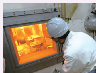
Am回収作業の様子
