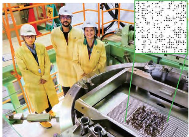
STACY更新炉(乱雑な燃料棒配置)の実験でフランス研究機関IRSN(現ASNR)と協力
