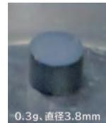
アメリカシウム-241の沈殿回収(左)と焼結後のペレット(右)
