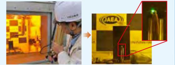
遠隔操作でAm封入ピンを挿入 熱電変換デバイスの起電力でLED発光
