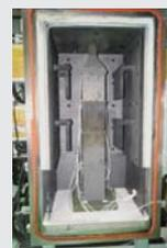
LEISAN (制御棒ブレード破損試験装置)の内部
