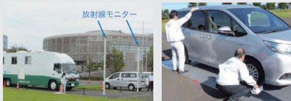
実車両を用いた車両ゲート型放射線モニターとサーベイメータによる汚染検査
