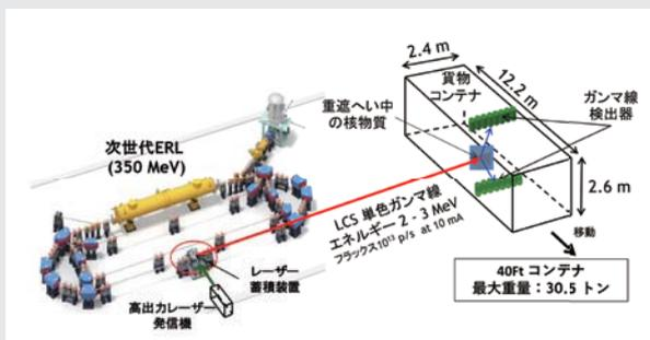
(例) 40フィート輸送コンテナの非破壊検査へのNRF技術の適用
